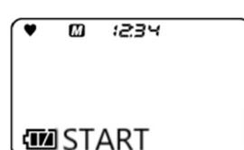
LCD が全点灯して、測定開始画面へ移ります。
