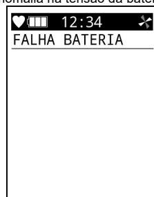
<Anomalia na tensão da bateria>
