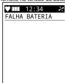
<Anomalia na tensão da bateria>
