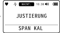
Nach Abschluss des Bump-Tests und der Gasjustierung werden die folgenden Ergebnisse angezeigt. Drücken Sie die ▲/AIR- oder die RESET/▼-Taste, um zwischen der Ergebnisanzeige hin- und herzuwechseln.
