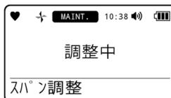
スパン調整が正常に行われると、結果が表示され、続けてスパン調整後の濃度が表示されます。
