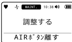
エア調整が正常に行われると、結果が表示され、続けてエア調整後の濃度が表示されます。
