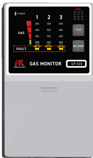
故障した対象のガス検知部の FAULT ランプが点滅
