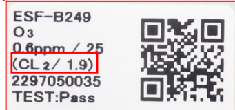
Beispiellekett mit Angabe von Ersatzgas und Umrechnungsfaktor (Beispiel: Ersatzgas: Chlor (Cl 2 ), Umrechnungsfaktor: 1,9)
