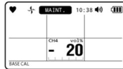
Die Basisgasjustierung wird durchgeführt.
