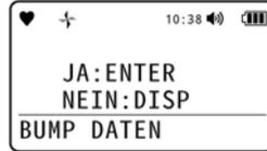
2 Drücken Sie die POWER/ENTER-Taste. Wenn die Gasjustierungsaufzeichnungen nicht angezeigt werden soll, drücken Sie die DISP/ESC-Taste.
