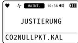
Wenn der CO<sub>2</sub> -Nullabgleich erfolgreich abgeschlossen wurde, wird das Ergebnis und anschließend die Konzentration nach dem CO<sub>2</sub> -Nullabgleich angezeigt.
