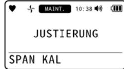
Wenn die Messspannenjustierung erfolgreich abgeschlossen wurde, wird das Ergebnis und anschließend die Konzentration nach der Messspannenjustierung angezeigt.
