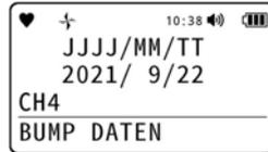
4 Drücken Sie die DISP/ESC-Taste. Die Anzeige kehrt zum Bildschirm in Schritt 1 zurück.
