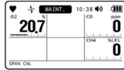
Die Messspannenjustierung wird durchgeführt.
