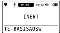
3 Drücken Sie die POWER/ENTER-Taste. Legt den Gastyp für die Basisgasjustierung fest. [ENDE] wird angezeigt und die Anzeige kehrt zum Bildschirm in Schritt 1 zurück.
