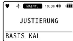
Wenn die Basisgasjustierung erfolgreich abgeschlossen wurde, wird das Ergebnis und anschließend die Konzentration nach der Basisgasjustierung angezeigt.
