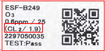
替代气体和换算系数的印刷参考图 （例：替代气体：氯（Cl 2 ）、换算系数：1.9）
