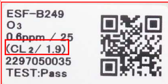
代替ガスと換算係数の印字イメージ (例: 代替ガス: 塩素 (Cl 2 )、換算計数: 1.9)
