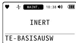
3 Drücken Sie die POWER/ENTER-Taste. Legt den Gastyp für die Basisgasjustierung fest. [ENDE] wird angezeigt und die Anzeige kehrt zum Bildschirm in Schritt 1 zurück.
