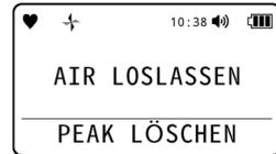
Der PEAK-Wert wird gelöscht und die Anzeige kehrt zum Bildschirm in Schritt 1 zurück.
