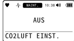
3 Drücken Sie die POWER/ENTER-Taste. Legt fest, ob eine Frischluftkalibrierung für den Kohlendioxidssensor durchgeführt werden soll. [ENDE] wird angezeigt und die Anzeige kehrt zum Bildschirm in Schritt 1 zurück.
