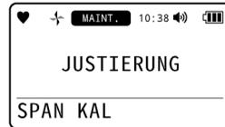
Wenn die Messspannenjustierung erfolgreich abgeschlossen wurde, wird das Ergebnis und anschließend die Konzentration nach der Messspannenjustierung angezeigt.
