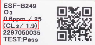
代替ガスと換算係数の印字イメージ (例: 代替ガス: 塩素 (Cl 2 )、換算計数: 1.9)
