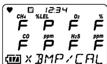
通氣測試（氣體調整）的結果
