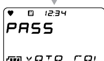
空氣調整後顯示現在的濃度，並返回步驟 1 的畫面。
