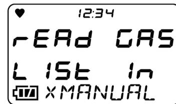
此外，可燃性感測器受到矽化物、鹵化物等污染影響時，會顯示如右側畫面。顯示如右側畫面時，可使用替換讀取功能的僅限「替換讀取限制時可否替換讀取」欄中記載○標記的氣體種類。欲對欄中記載×標記的氣體種類使用替換讀取功能時，請洽銷售店或最近的本公司營業所。
