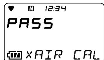
A concentração atual aparece após o ajuste de ar fresco e o visor retorna à tela no Passo 1.
