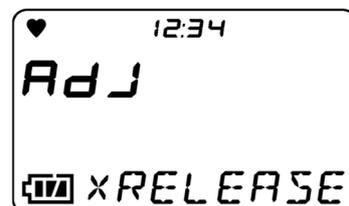
O produto retorna automaticamente ao modo de medição assim que o ajuste do ar for concluído com êxito.
