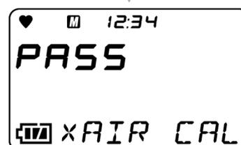
A concentração atual aparece após o ajuste de ar fresco e o visor retorna à tela no Passo 1.
