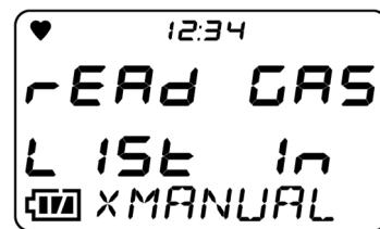
此外，可燃性传感器因硅化合物、卤化物等而受到中毒影响时，显示右侧画面。显示右侧画面时，可以使用转换功能的，只有限制转换时可否转换栏内列出的带○标记的气体种类。如需继续对带×标记的气体种类使用转换功能，请咨询经销商或就近的本公司营业网点。
