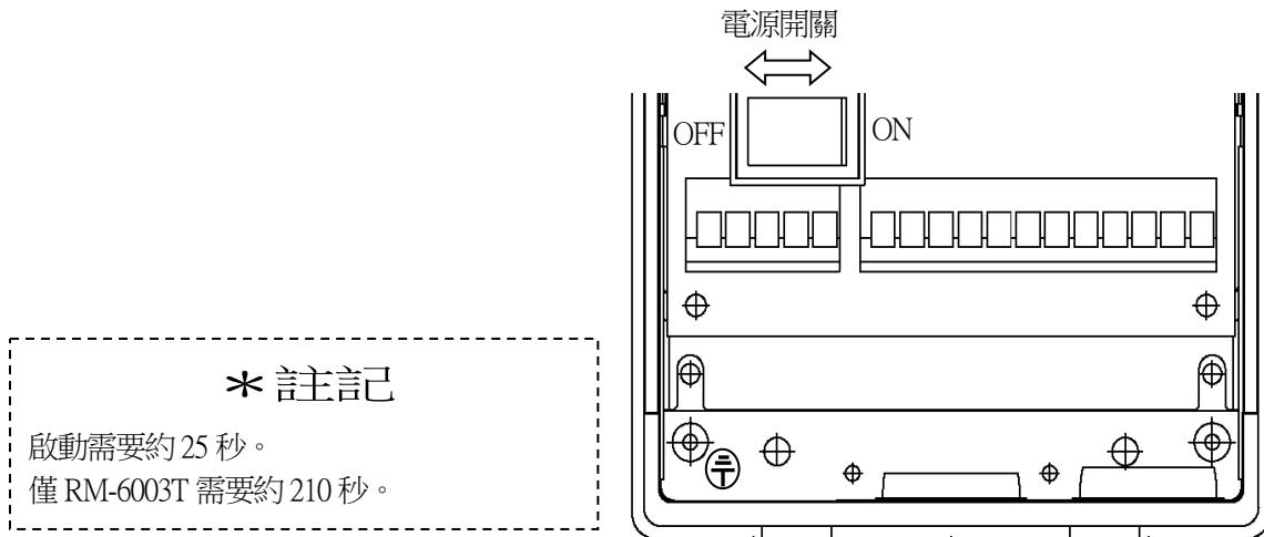
«啟動流程（約 25 秒，機器的系統確認、切斷警報）»（以下是 GP-6001 的顯示示例）
