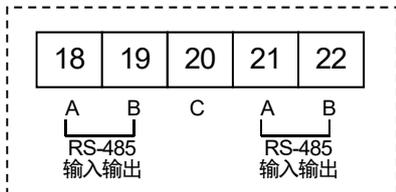
※ 适用棒状端子: 216系列 (WAGO制)、适用电线: 尺寸 0.5~2.0mm<sup>2</sup> (绞线) 或者φ0.8~2.0mm (单线)·剥皮长度10~11mm
