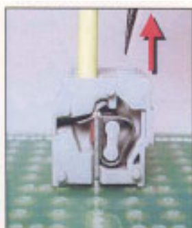
⑤ 將電線插到底後，請按住電線拔出螺絲起子。
