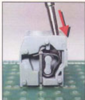
①ドライバーを操作用スロット(角穴)に斜めに差し込みます。
