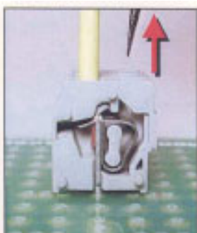
⑤電線を突き当たるまで差し込んだら、電線を押さえたまま、ドライバーを抜いて下さい。
