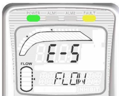
※E-5 FLOW (流量異常)
