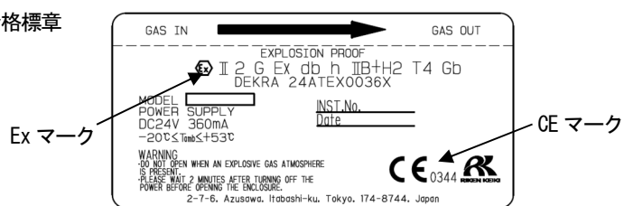
ATEX, CE マーキング仕様の銘板例 (DC 電源仕様のみ)
