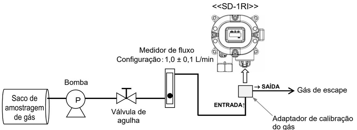
Tipo de sucção (gás de calibração: Gás ou gás solvente)
