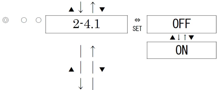
[2-4.2] Configuração do ponto de ajuste do alarme
