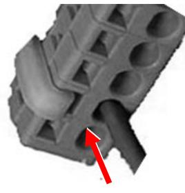
Mantendo a alavanca para baixo, insira o fio no orifício do fio (redondo) até que atinja o ponto mais profundo. Quando se libera a alavanca o fio é fixado.
