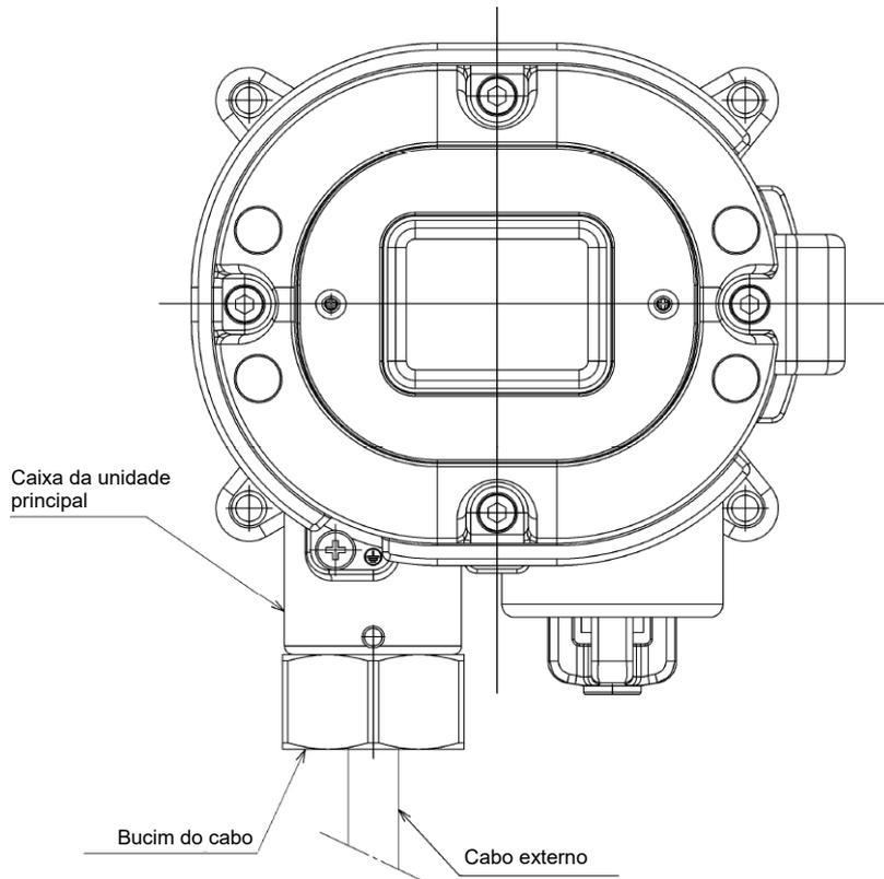
Conforme mostrado na figura abaixo, ligue as peças pela ordem seguinte: bucim do cabo, arruela excêntrica, arruela e vedante de borracha no cabo e, em seguida, conecte o cabo à unidade principal e depois aparafuse o bucim do cabo para apertar o vedante de borracha.
