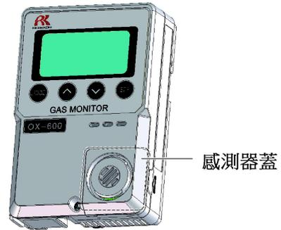
將硬幣筆直接入本儀器右下方的凹槽，感測器罩蓋就會升起來。
