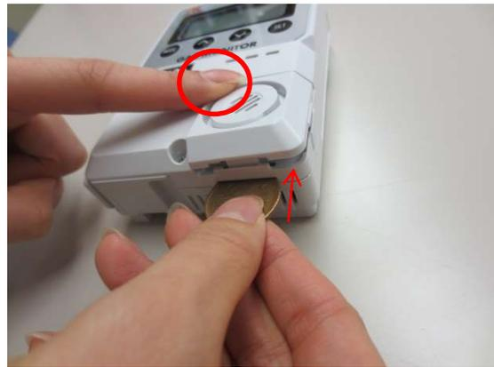
拆下感測器罩蓋即可確認感測器。
