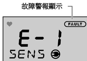
從故障狀態恢復正常時，從電源接通後的作動（初始清除）重新啟動。
