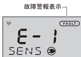
故障状態から正常に復帰した場合は、電源投入後の動作(インシヤルクリア)から再スタートします。
