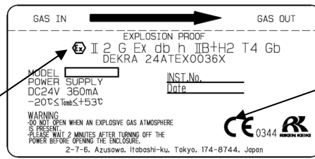
ATEX, CE 标志规格的铭牌例 (仅 DC 电源规格)
