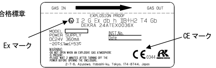
ATEX, CE マーキング仕様の銘板例 (DC 電源仕様のみ)
