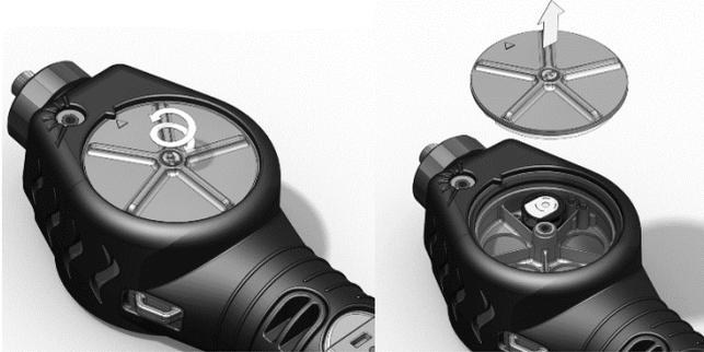
センサカバーの中心のネジを緩め、小さなコインまたはマイナスドライバーで回転させ、センサカバーを外します。センサカバー内部にあるセンサシールは、そのままの状態に保ちます。
