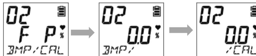
Após uma falha no teste de resposta, a calibração é executada se especificado na configuração. Após a conclusão da calibração, o resultado da calibração é exibido na tela [BMP/CAL] (lado direito da linha do meio), seguido pela leitura no momento do teste de resposta e pela leitura de calibração.
