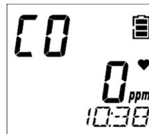
**2 Solte o botão AIR quando o visor LCD mudar de [Air HOLD] para [AdJ RELEASE].**
